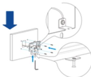
Gire el tornillo M3x10.5 en el orificio inferior del soporte hasta que la cola se alinee con el borde. Luego fije el soporte de pared en la pared con cuatro tornillos ST4x20. Si hay un cable a tierra que se va a conectar, use el tornillo M3x6 para fijarlo - en el soporte de pared.
