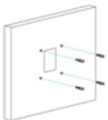
Una vez que se hicieron los orificios de fijación, inserte los asientos de fijación de tornillo provistos.
