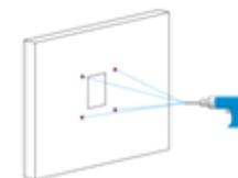
Retire el soporte de pared, luego use un taladro de mano de 5 mm para hacer los cuatro orificios de fijación en la pared que marcó antes.
