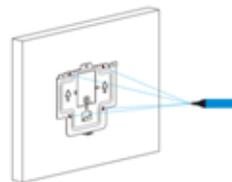
Alinee el agujero cuadrado del soporte de pared con el agujero excavado antes, luego marque los cuatro agujeros de fijación a través del soporte de pared en la pared.
